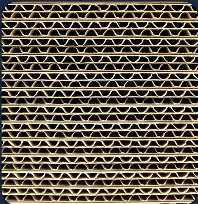
El cartón corrugado permite, en su forma de caja o embalaje, el transporte de mercancías de una manera segura por su resistencia así como su versatilidad para ajustarse a especificaciones del cliente. De la misma manera, es un material amigable con el medio ambiente, ya que permite ser reciclado en varias ocasiones. El cartón corrugado se utiliza para la fabricación de cajas, separadores, contenedores, y exhibidores.
